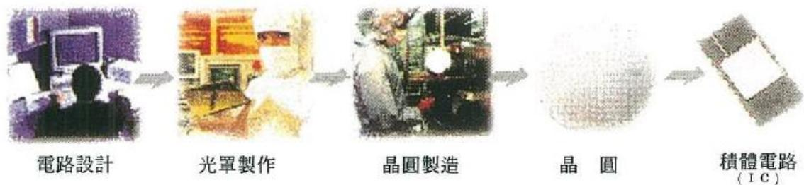
圖 2 晶圓製造流程
