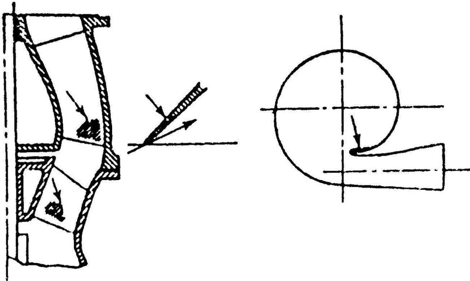
(a) 泵殼擴散葉片靠近進口低壓處易發生漩渦真空。(b) 泵殼舌端低壓面易發生漩渦真空。
