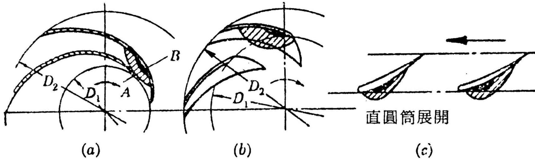
葉片易發生漩渦真空處，(a)低比速率；(b)中比速率；
