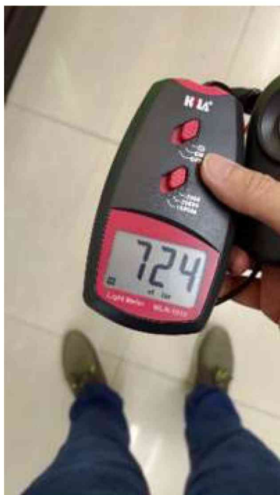
圖 5、港興門市基線情境現場照度量測
